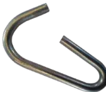
05-00007 GANCHO PARA PUNTAL ESPAÑOL EN ACERO Ø10mm L127mm CINCADO
